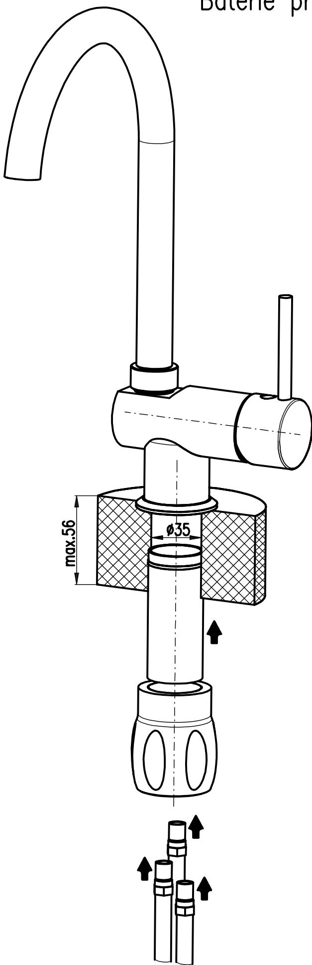
ke snížení průtoku je možné do přívodní hadice vložit přiložený plastový omezovač průtoku.
