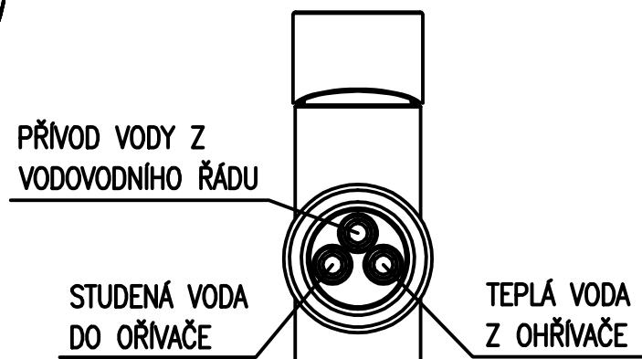
U BEZTLAKOVÝCH OHŘÍVAČŮ PŘI ZAPNUTÉM OHŘEVU (SVÍTÍ KONTROLKA), NEPATRNĚ ODKAPÁVÁ Z RAMÍNKA VODA. JE TO ZPŮSOBENO ROZTAŽNOSTÍ VODY PŘI OHŘEVU. ODKAPÁVÁNÍ PŘI OHŘEVU TEDY NENÍ ZÁVADA.
